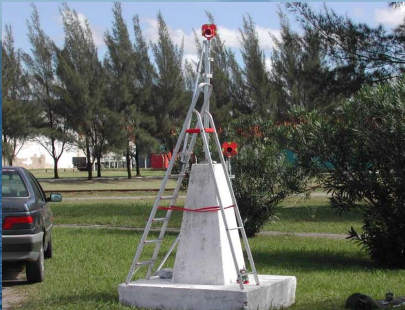
Uma estação permanente SIRGAS junto ao DVB foi instalada em junho/07 em substituição à estação IMBI/SIRGAS. Foi provida a conexão entre as duas estações por 17 dias de observações GPS e adicionalmente por métodos topográficos e de travessia.
