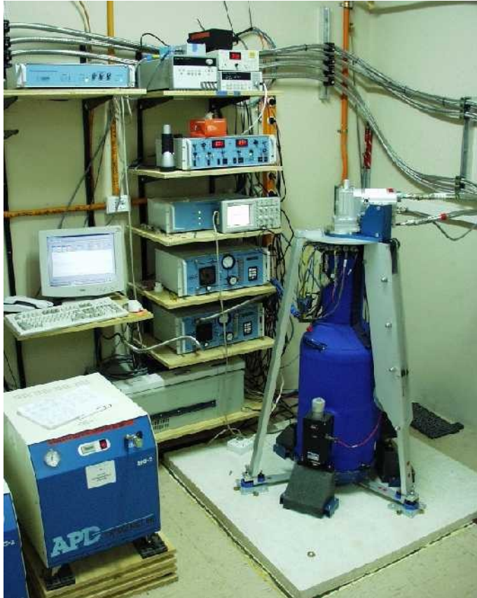
gravímetro superconductor SG38 único instrumento en America Latina
