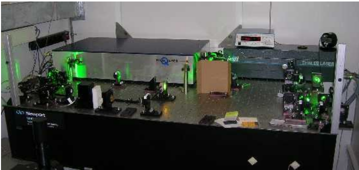
sistema láser, 100Hz, 15mJ, 40ps
