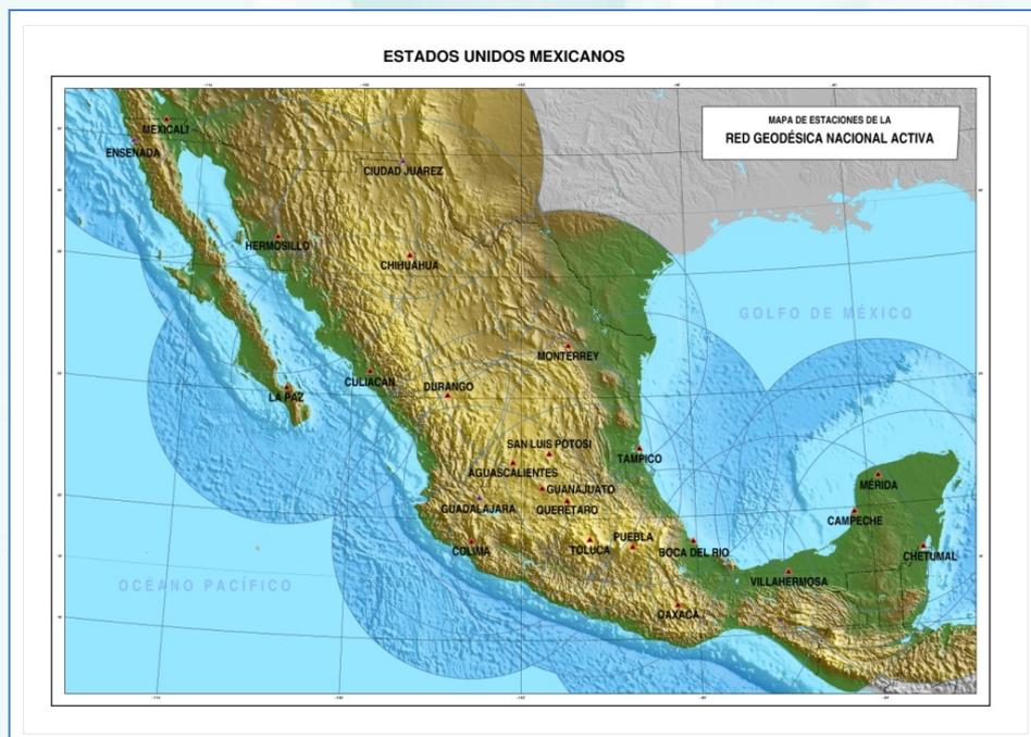
INEGI norma actualmente la operación de **24 estaciones permanentes GNSS**, base principal para el desarrollo de la Red Geodésica Nacional Pasiva y para los levantamientos geodésicos en México en el ITRF08, época 2010.0
