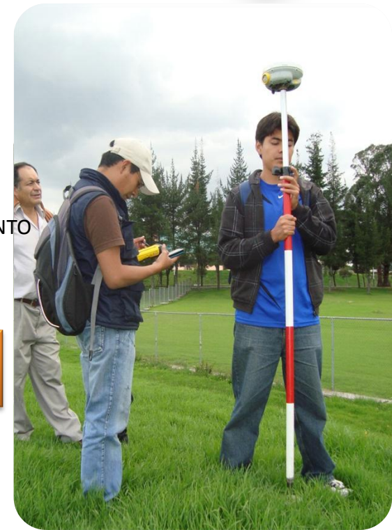
Fig 3. Mediciones con NTRIP
