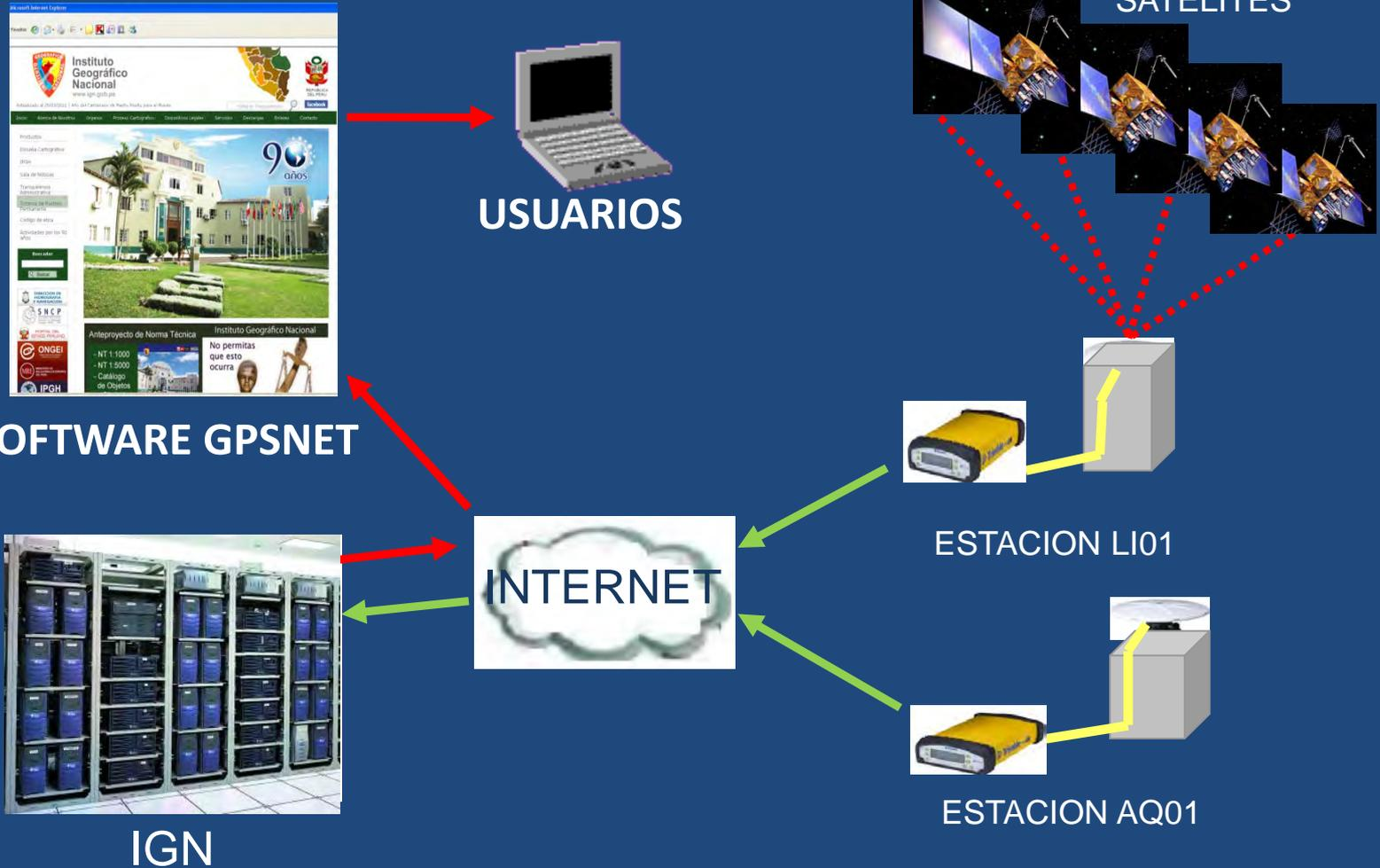
El Software GPSNET permite realizar procesamiento en línea RTK (tiempo real) en las modalidades de “Single Station” y “Multistation”, el empleo de la tecnología de Estación de Regencia Virtual (Virtual Reference Station) VRS.
