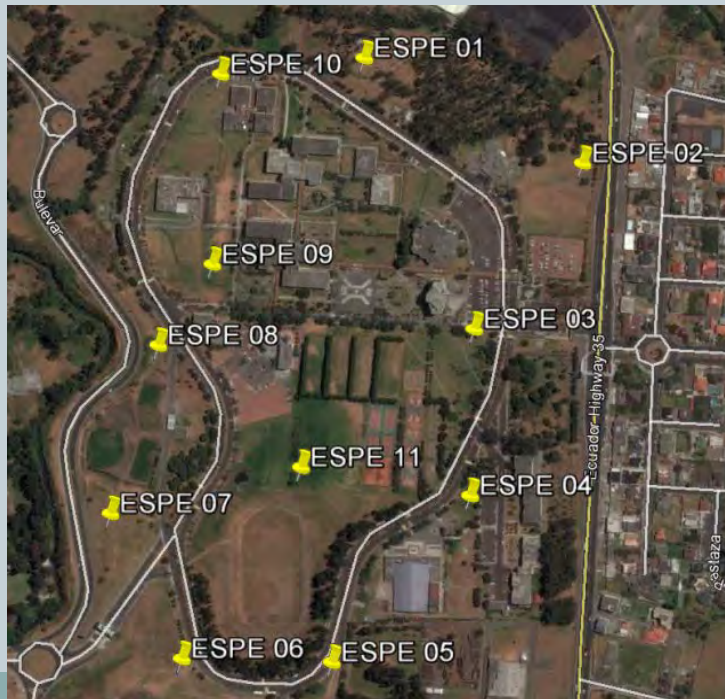
Figura 5. Ubicación Aproximada de la red de puntos de control para el vuelo ESPE.
