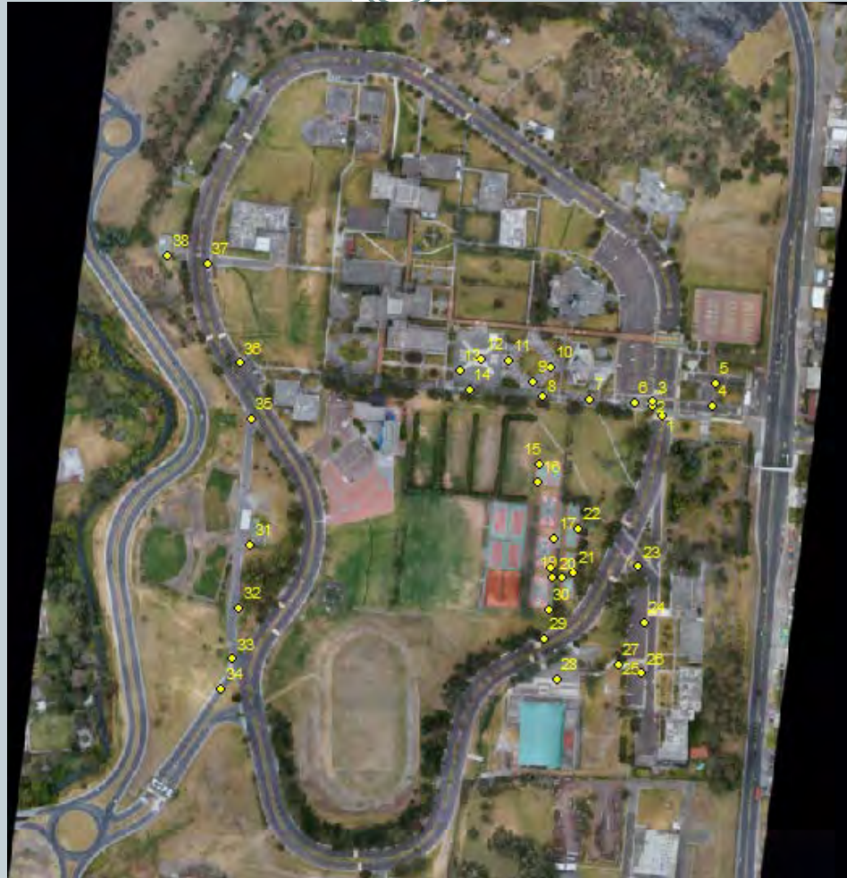
Figura 8. Puntos GPS de precisión sobre el mosaico Ortorectificado.
