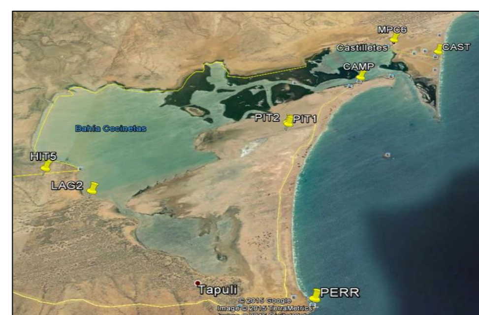
Figura 6. Red geodésica de la Laguna de Cocinetas, vinculada al marco de referencia continental SIRGAS.
