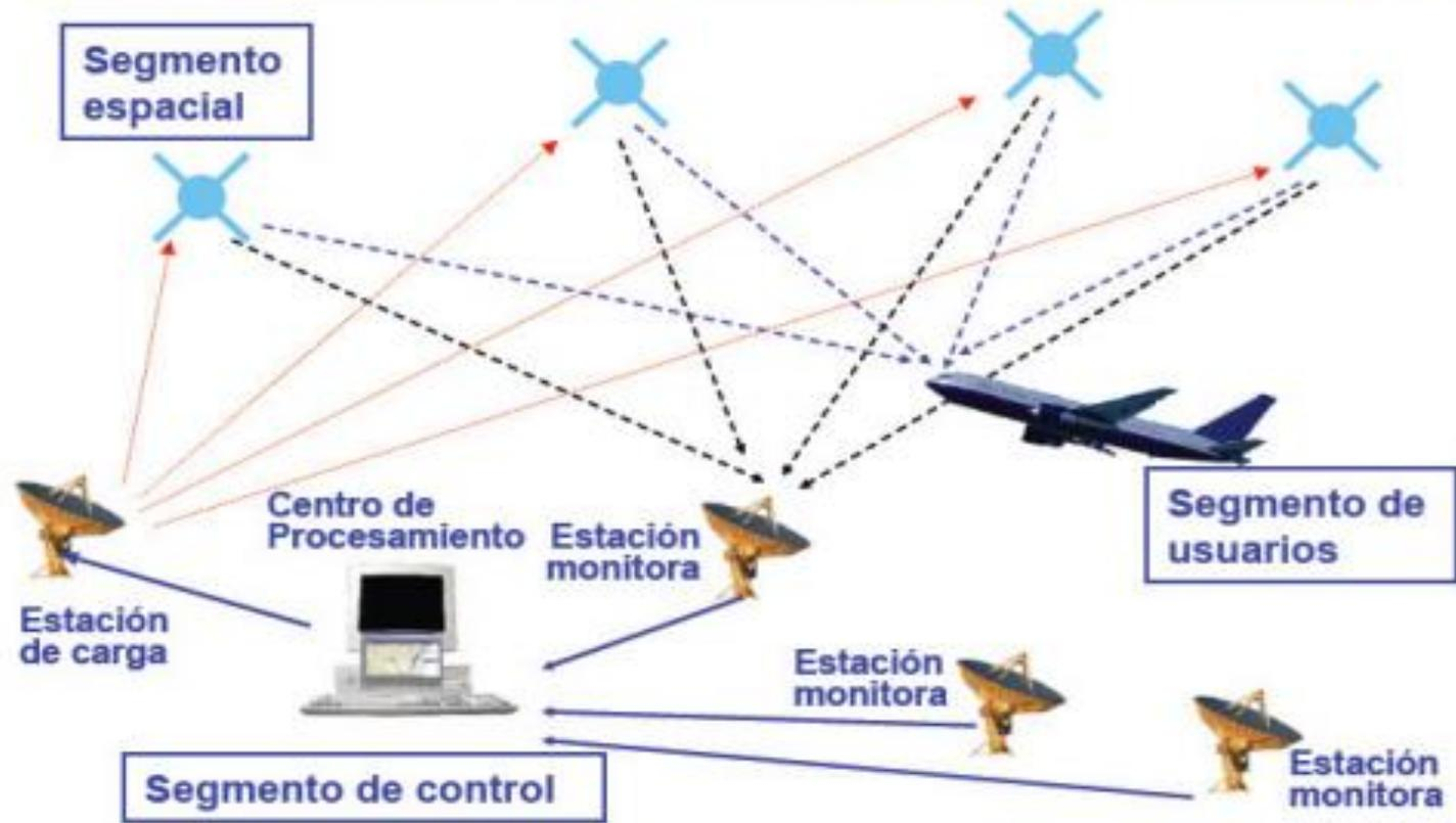
FIGURA 1.4 Funcionamiento de un GNSS <sup>[19]</sup>
