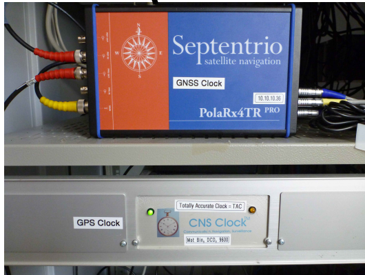
escala local vinculada con UT por reloj de GNSS 10^{-9}
