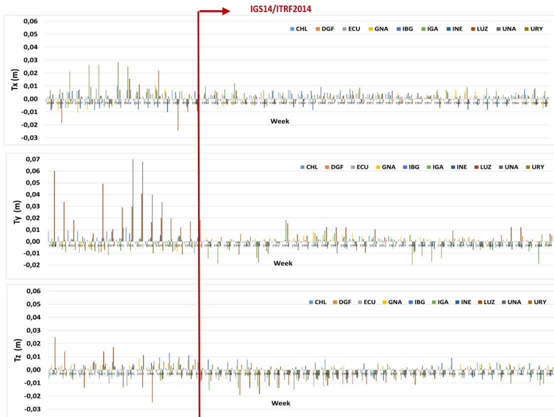
Figura 12. Parámetros de traslación entre soluciones individuales de cada CA respecto a la solución combinada, periodo 2016-2017 [35].
