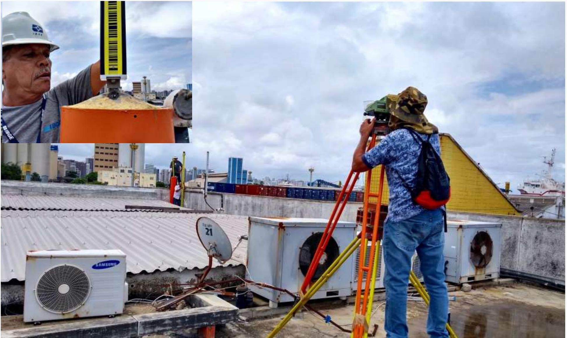
Conexão da estação CEFT por nivelamento geométrico
