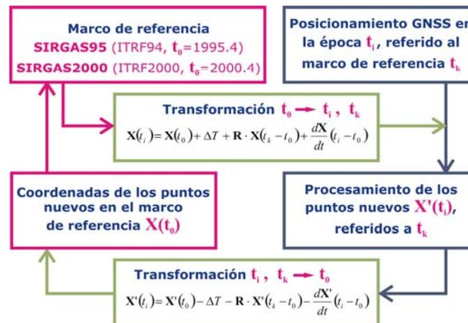
Figura 9. Transformación de coordenadas entre diferentes épocas de referencia y diferentes realizaciones ITRF.
