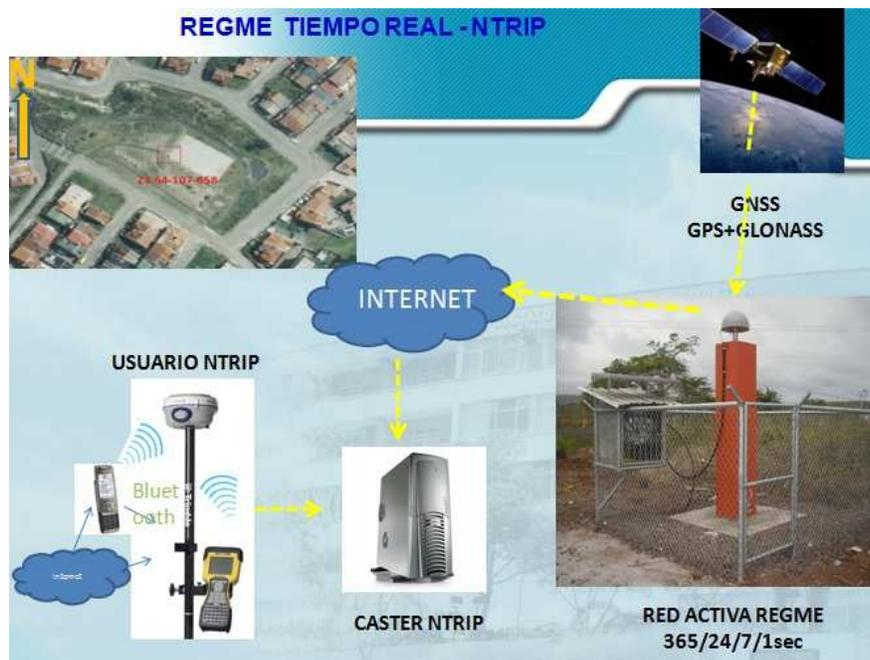
Figura No. 16: REGME - NTRIP, posicionamiento en tiempo real.
