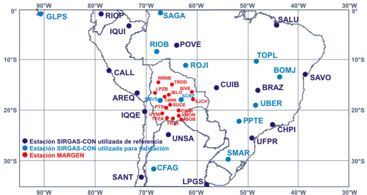
**Figura 4.** Estaciones SIRGAS-CON utilizadas para el ajuste de la red MARGEN. 15 estaciones fueron introducidas como de referencia, mientras que las 12 restantes sirvieron para validar los resultados obtenidos.
