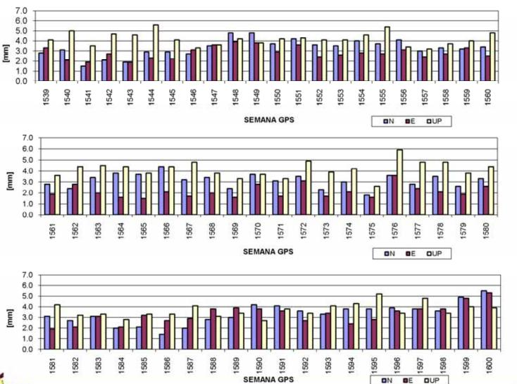
valores de Los **RMS** para las soluciones libre generadas por IGA con relación a las soluciones de IGS-RNAAC-SIR varían la componente norte en promedio la para mm, componente este es de 6.7 mm y la componente vertical de 7.3 mm
