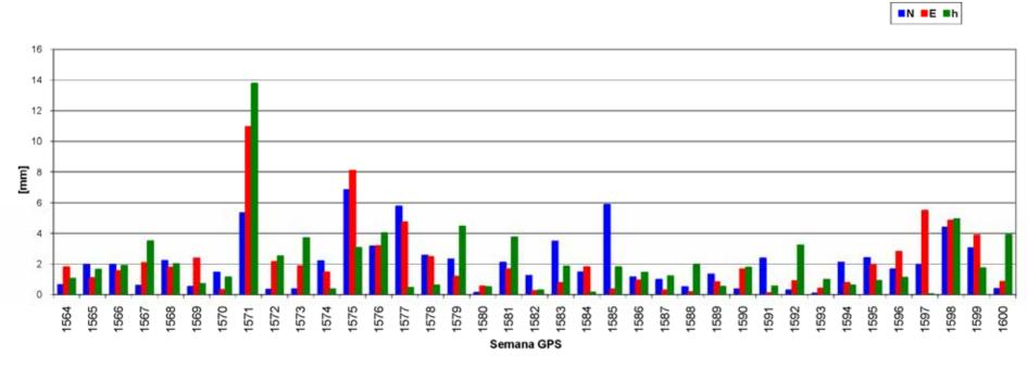
Los valores promedio de los residuales entre las soluciones libres de IGA con relación a LUZ para el periodo comprendido entre las semanas GPS 1539 y 1600 varían en la componente N=2.04 mm, E=2.12 mm y U=2.11 mm
