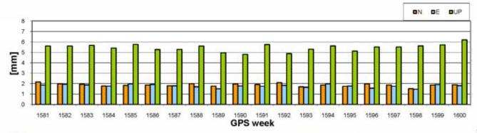
La evaluación diaria de la repetibilidad de las coordenadas diarias de las estaciones procesadas por IGA, nos muestra alta consistencia en la componentes N y E (N=1,98 mm E= 1,99 mm), mientras que esta disminuye para la componente U=5,66 mm
