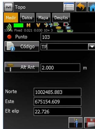
El Caster generador de correcciones NTRIP, calculan y corrigen en tiempo real las posiciones de los receptores rover de campo y actualmente estamos testeando las precisiones obtenidas en todas las regiones de ambos países, pruebas que han dado excelentes resultados con precisiones DGPS menores a 30 cm en Tiempo real e inferior a 5cm RTK, precisión excelente para todas las tareas de mapeo, SIG topografía y cartografía.
