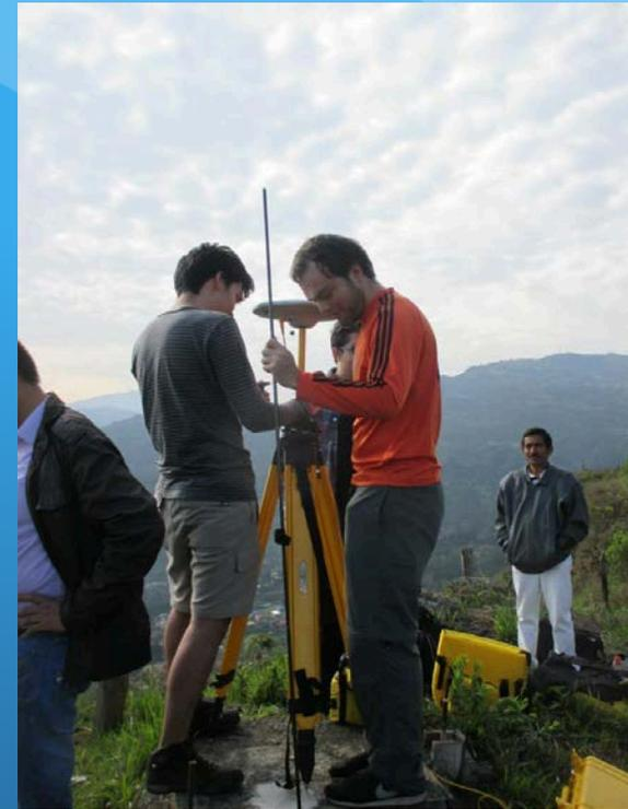
GPS diferencial: Receptores Trimble R7 con antenas geodésicas (Zephyr-2 Geodetic)
