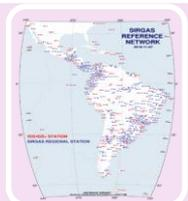
SIRGAS es la definición, realización y mantenimiento del sistema de referencia geocéntrico tridimensional. Su realización es una densificación regional del Marco Internacional de Referencia Terrestre (ITRF).
