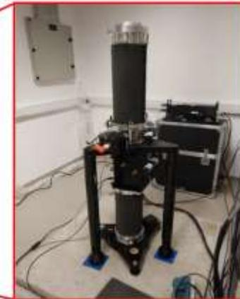
Gravímetro Superconductor SG038
