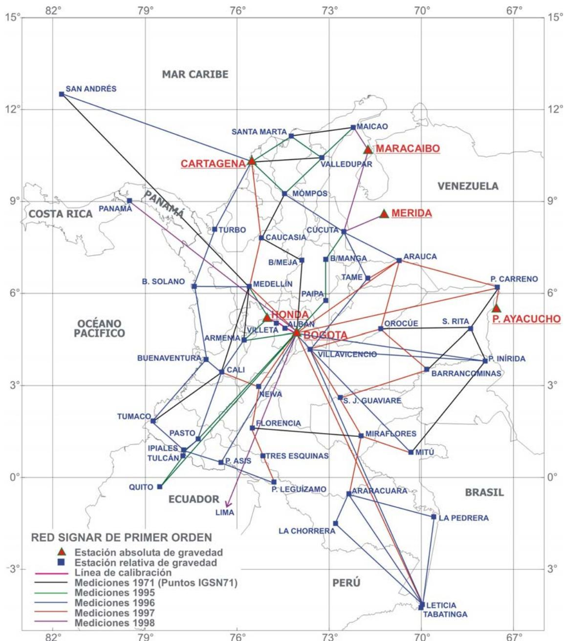
**Figura 5.** SIGNAR: estaciones absolutas de gravedad y red gravimétrica de primer orden
